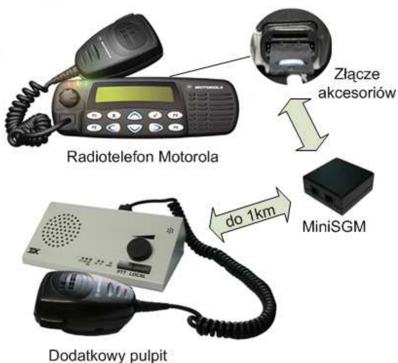
Schemat przedstawiający zasadę działania MiniSGM z pulpitem dodatkowym
