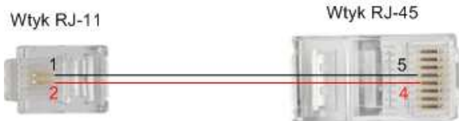
Kabel łączący moduł MiniSGM z pulpitem dodatkowym (dla pulpitu w wersji z gniazdem linii RJ-45)
