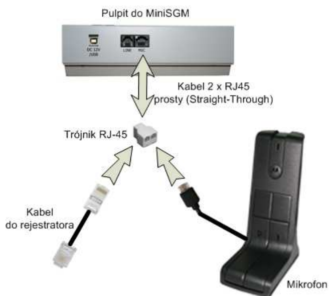
Sposób podłączenia Pulpit MiniSGM z rejestratorem oraz mikrofonem zewnętrznym (dotyczy wersji produkowanych od listopada 2012 – MiniSGM2)
