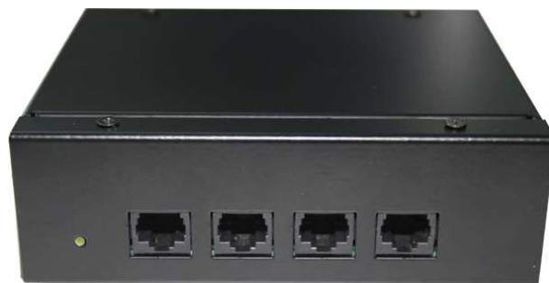
Multipanel (widok z przodu) (widoczne 4 gniazda do podłączenia manipulatorów radiotelefonów – tylnych części RLN)
